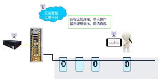
超高灵敏度DVS仪非接触式探查光缆路由
