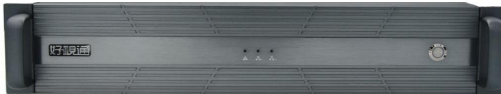
HST-MCU8000 是一款高可靠、高性能的电信级多点控制单元，采用高度集成化设计，集视频、音频和数据通讯于一体。是实现多点高清视频会议的核心汇接设备，用于连接所有视频会议点，提供分屏功能，同时还承担着会场切换等会议管理功能。支持广泛的网络协议，可灵活应用于各类视频会议系统，并可全面支持高清、标清视频会议终端接入，视讯 MCU 服务器根据部署架构分为单机版、级联、集群三种形式。
