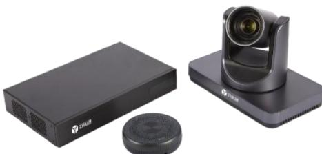
CX300 是一款适用于各类会议室的全能型云视频终端，高度集成，灵活扩展。采用国产化专业芯片，实现 AVC、SVC 双擎驱动。通信总线技术，实现摄像机与主机“一线通”，极大简化集成布线工作。
