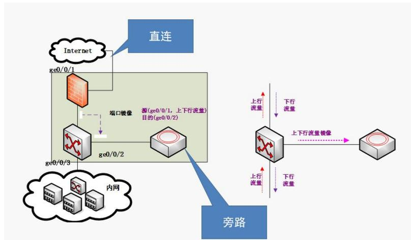
根据拓扑，在用户内外网之间放置等保直通车。在这个组网设计中，用户的业务系统与虚拟防火墙部署在同一虚拟网络内，用户内网服务器与防火墙的网关需要配置指向防火墙。通过虚拟防火墙，内网服务器与互联网网关隔离，访问内网服务器的流量都要进出虚拟防火墙。
