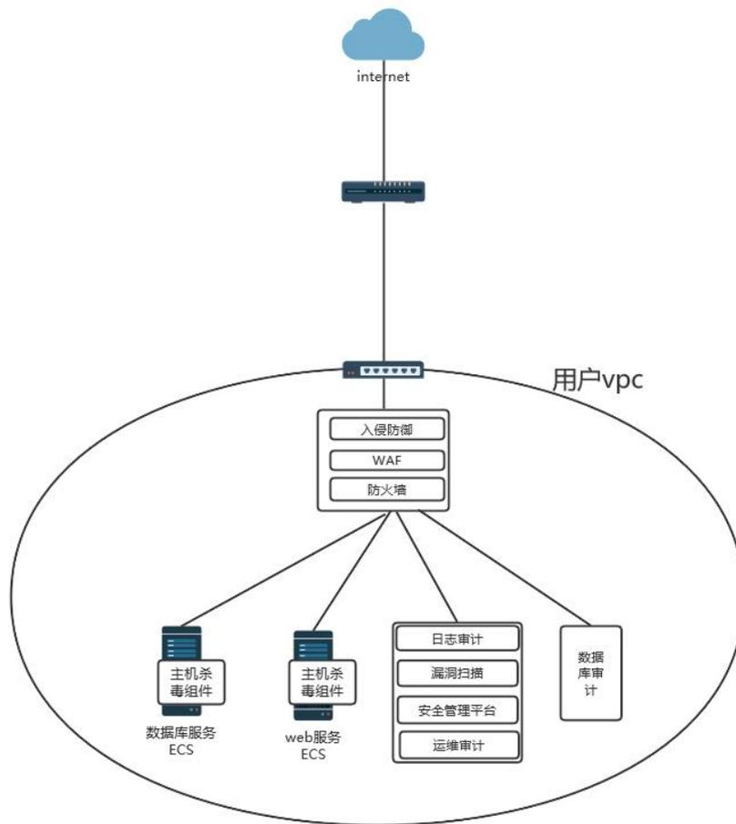
在这个组网设计中，用户的业务系统与虚拟防火墙部署在同一 VPC 内，用户 VPC 内网服务器与防火墙的网关需要配置指向防火墙。通过虚拟防火墙，内网服务器与互联网网关隔离，访问内网服务器的流量都要进出虚拟防火墙。
