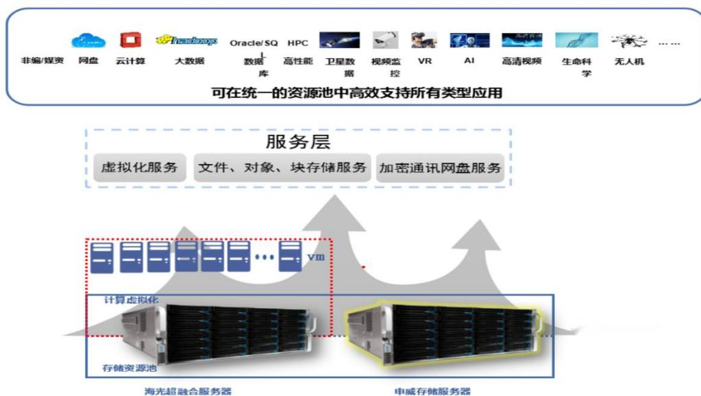
LV 级架构图可得知，为保障数据安全可靠的的同时，还需提供更高效的虚拟化资源，采用 1 台海光/鲲鹏节点+1 台申威节点组成集群。由海光/鲲鹏节点提供计算虚拟化服务，由海光/鲲鹏和申威节点异构混合构建统一存储池，共同为上层业务提供存储服务，满足虚拟化服务的存储需求，也保障数据安全可靠。
