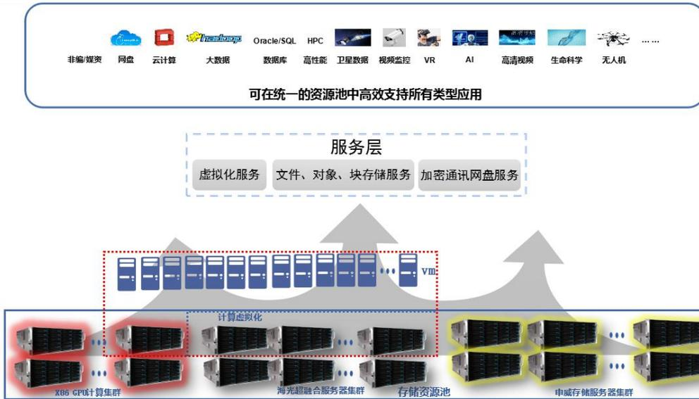
J 级系统采用海光/鲲鹏服务器集群提供虚拟化服务，x86 GPU 集群提供 GPU 计算资源，整合海光/鲲鹏集群、申威集群、x86 集群上的硬盘资源构建统一存储资源池，为虚拟化服务及 GPU 计算资源提供高安全、高性能的存储服务。
